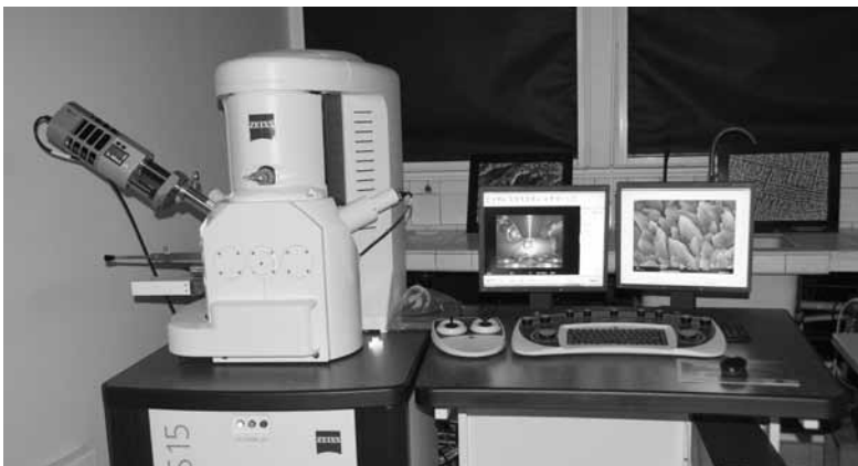
Microscope électronique à balayage à pression variable (©IRD-A.Aing)
